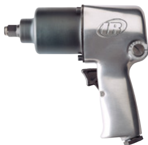
231C Llave de impacto de 1/2" Torque máximo= 600 Lbs-pie
